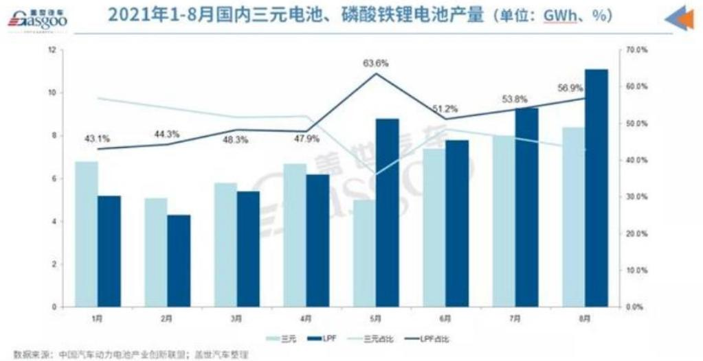
从动力电池产量上看, 磷酸铁锂电池的产量逐步走高, 其占比也逐渐增大。目前三元锂电池和磷酸铁锂电池的优缺点互补, 短时间内不会出现任何一方的一家独大局面。不过磷酸铁锂电池依靠自己更高的安全性和更低的成本在产量上反超了三元锂电池。
